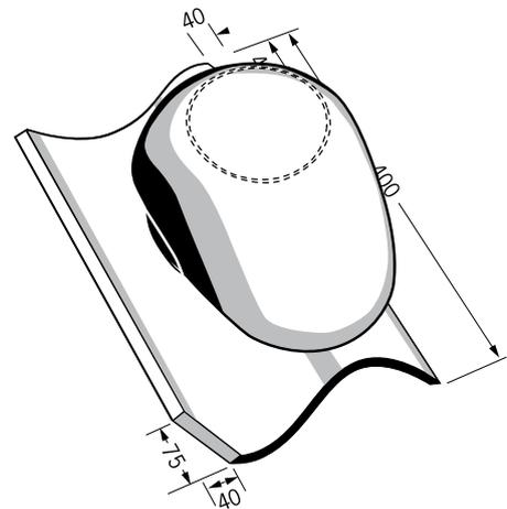
\* bei Verwendung als Sanitärziegel Deckel einfräsen
